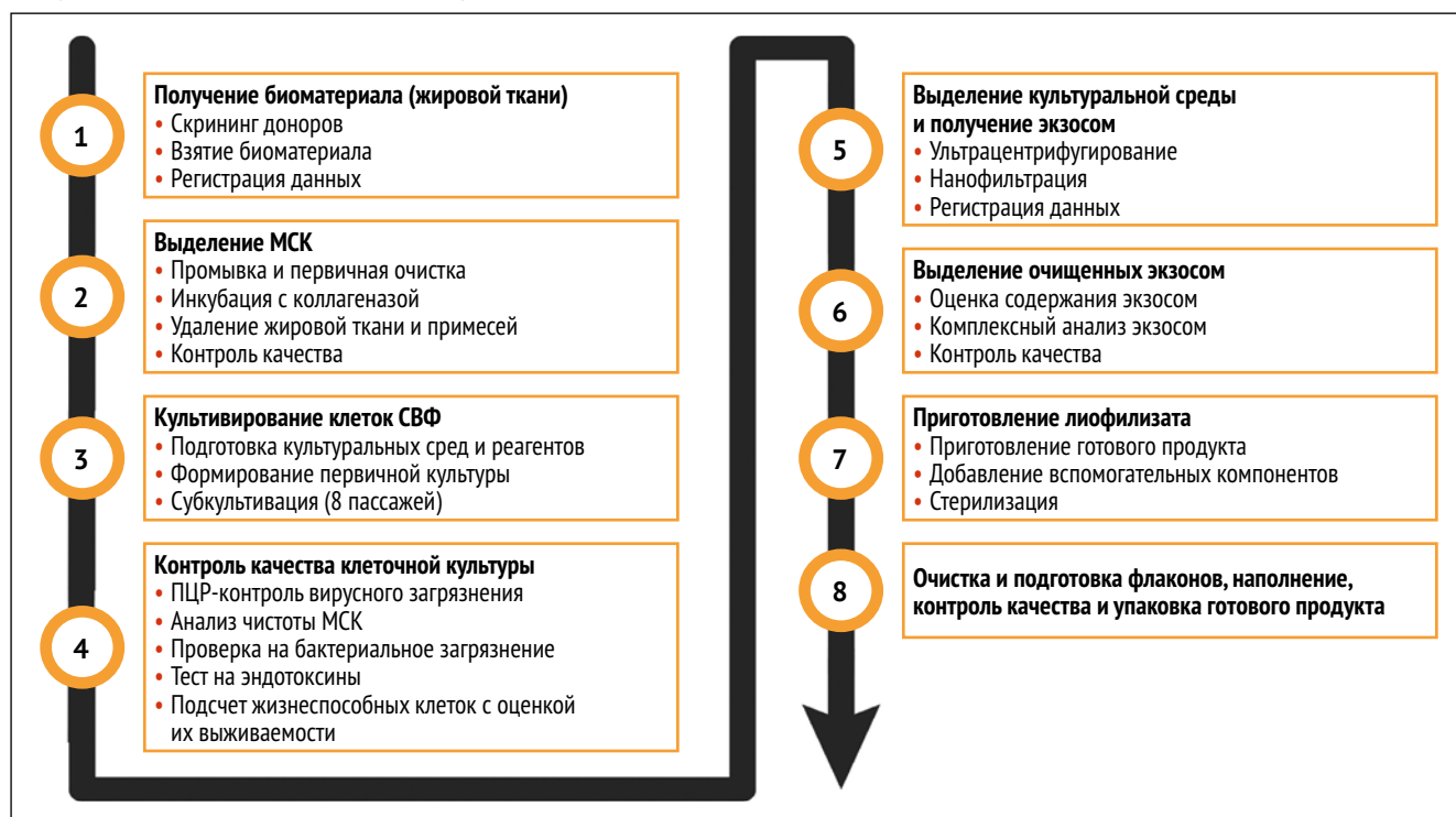
● Рисунок 3. Процесс производства Creabello EXO ● Figure 3. Creabello EXO manufacturing process
